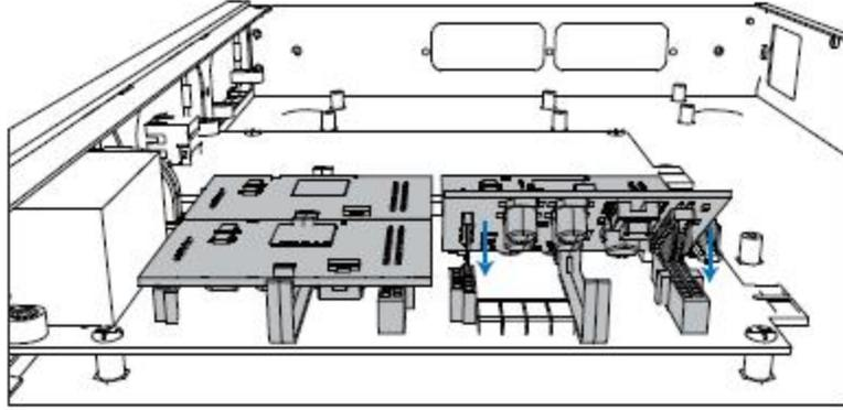
**步骤 6** 如果设备配有 GSM/3G 模块，请按照图示安装 SIM 卡。
