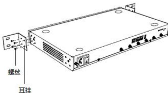
**步骤 2** 将设备放置在 19 英寸机架中，并使用机架的专用安装设备将耳挂固定到机架。
